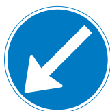
D 15 ”Påbudt passage”
